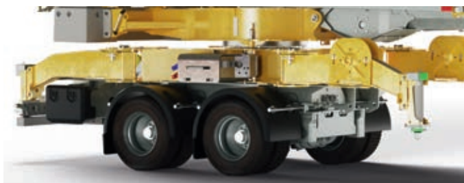
Doppelt gelenkte Achse +20°/-20°
