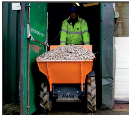
Mit Mehrzweckreifen erlauben die Abmessungen das Durchfahren schmaler Eingänge und den Einsatz bei beengten Platzverhältnissen.
