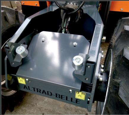
Robuste Stahlenschutzabdeckung mit vorderem Eingreifschutz verhindert Schäden an dem Hydraulikkreislauf.
