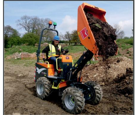
Hydraulischer, hoher Kipp-Mechanismus für Nutzlasten bis 1 Tonne.
