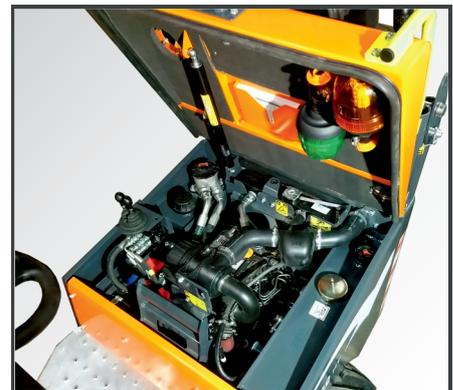
Guter und übersichtlicher Zugang, mit selbstsichernder Gasdruckfeder, zu den wichtigsten Bauteilen des bewährten YANMAR 3TNY76 Dieselmotors.
