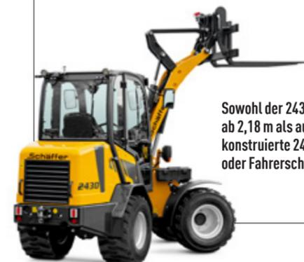
Sowohl der 2430-2 mit einer Bauhöhe ab 2,18 m als auch der sehr niedrig konstruierte 2430 SLT sind mit Kabine oder Fahrerschutzdach erhältlich.
