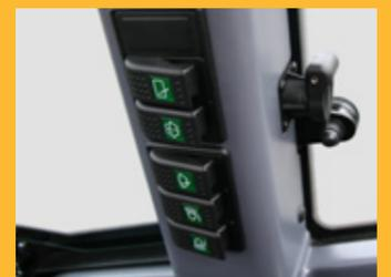
Zusammengefasste Schalterleiste, Steckdose mit Dauerstrom
