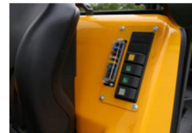
Die elektrischen Sicherungen können einfach kontrolliert und ausgetauscht werden.
