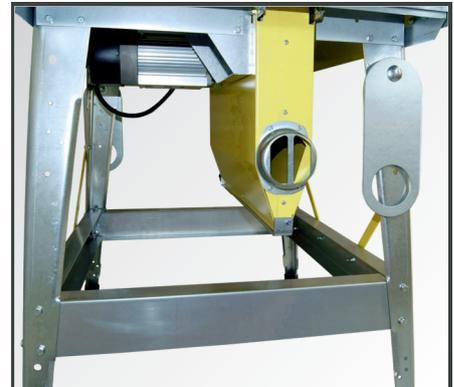
Ein Späneabsauganschluss befindet sich direkt am Spankasten. Zwei Kranösen, für ein leichtes Umsetzen, an den Tischbeinen.
