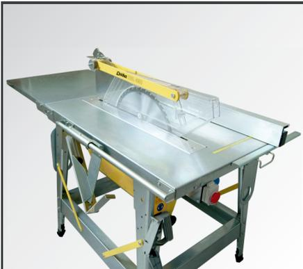
Für größere Werkstücke ist der gleitlagergeführte Queranschlag, wie auch die Tischverlängerung, auf- & abklappbar und der Längsanschlag abnehmbar.
